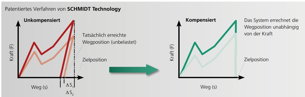
Bei Fügeprozessen schwanken die Einpresskräfte typischerweise um 30 bis 40%. Beim freien Positionieren sowie beim Werkzeugfestanschlag wird unter Last jeweils die gleiche Zielposition erreicht. Wird nun das Bauteil entlastet, erhält man, abhängig von der Einpresskurve, unterschiedliche tatsächlich erreichte Ziel-
