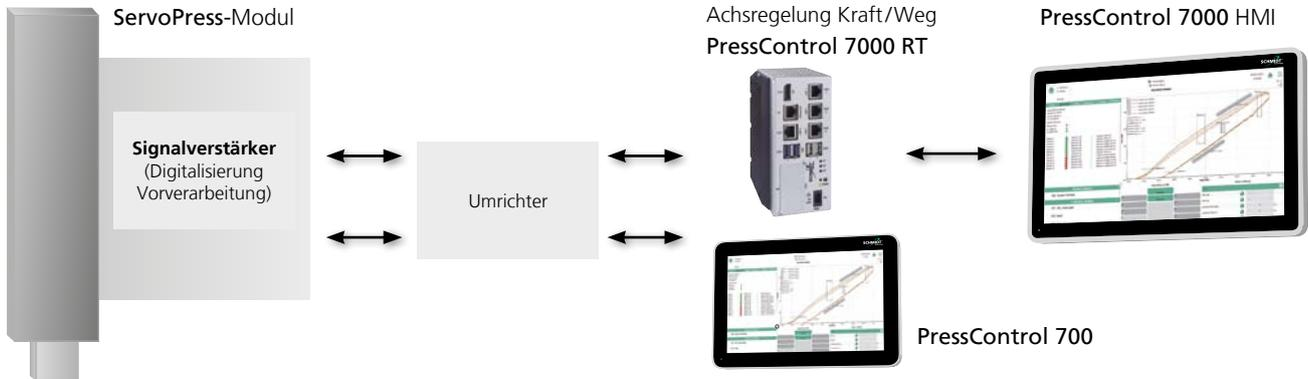
**SCHMIDT® ServoPress-Module** arbeiten mit einem echten Kraftregelkreis (Kraft als Führungsgröße); das heißt:
