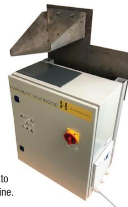
Modulo di misura M-Ray personalizzato sviluppato per un costruttore di macchine.
