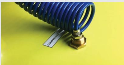
Primo piano dell'ingresso per l'aria pressurizzata su un sistema di misura Marveloc-CURTAIN conforme alla normativa ATEX.
