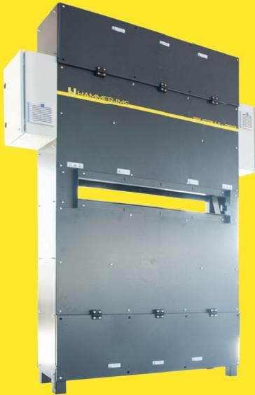
Miglioriamo continuamente i nostri sistemi per farli durare più a lungo. La nostra tecnologia Edge-Vision-4.0 è montata su strutture fisse in acciaio. Incapsuliamo il nostro sistema per evitare la polvere sulle lenti e sugli interni, riducendo così al minimo la manutenzione e i tempi di inattività. I nostri sistemi sono robusti, affidabili e facilmente manutenibili, proprio come le nostre macchine di misura basate su Marveloc, rinomate per il loro funzionamento preciso e affidabile.
