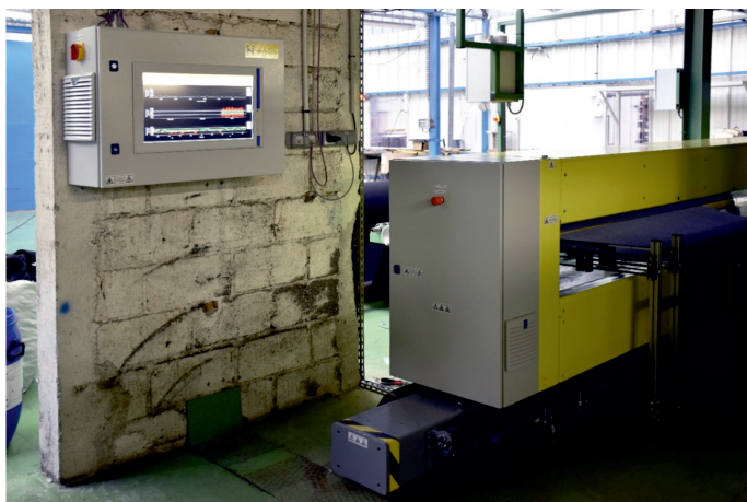
Fig. 2 Hammer-IMS Basisgewichtsmesslösung von Silac Industrie zur Inline-Messung der Einheitlichkeit der Grammatur von Filzen und Vliesstoffen
