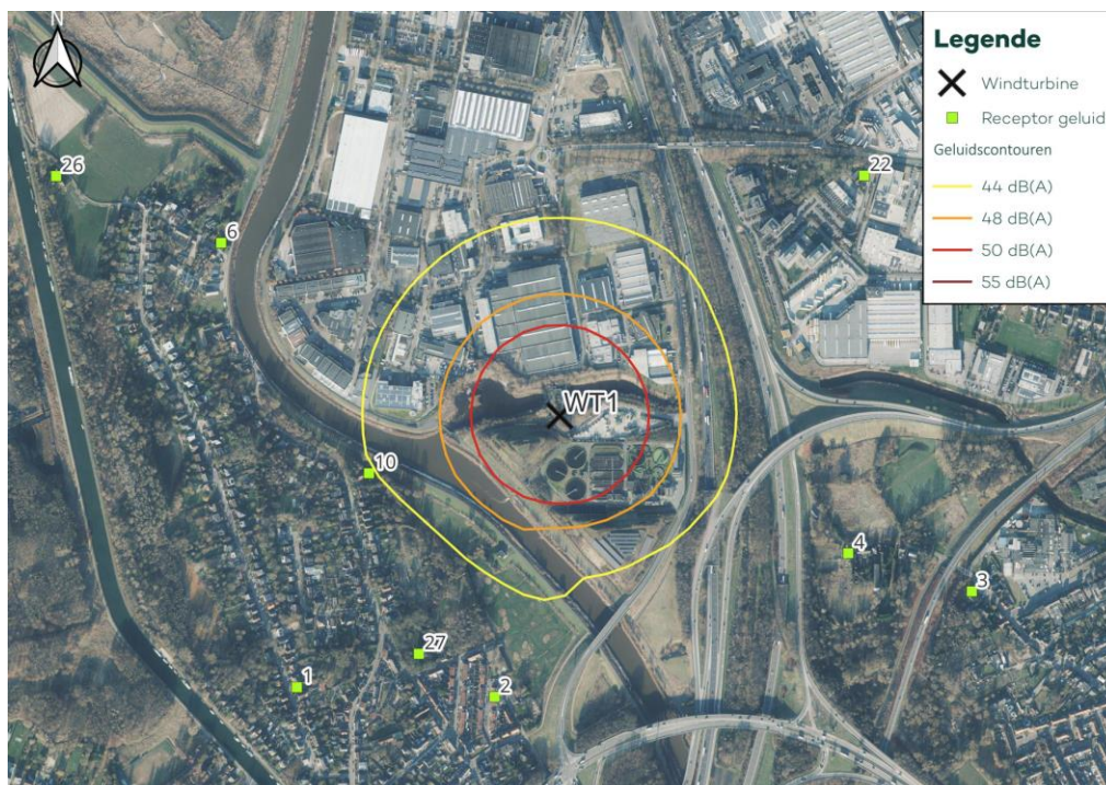
Figuur 5: Voorbeeld geluidsimpact (geluidscontouren dagperiode in dB(A)) van een realistisch turbinetype dat in aanmerking komt bij vergunning van het dossier (Enercon E138 op 130m ashoogte)
