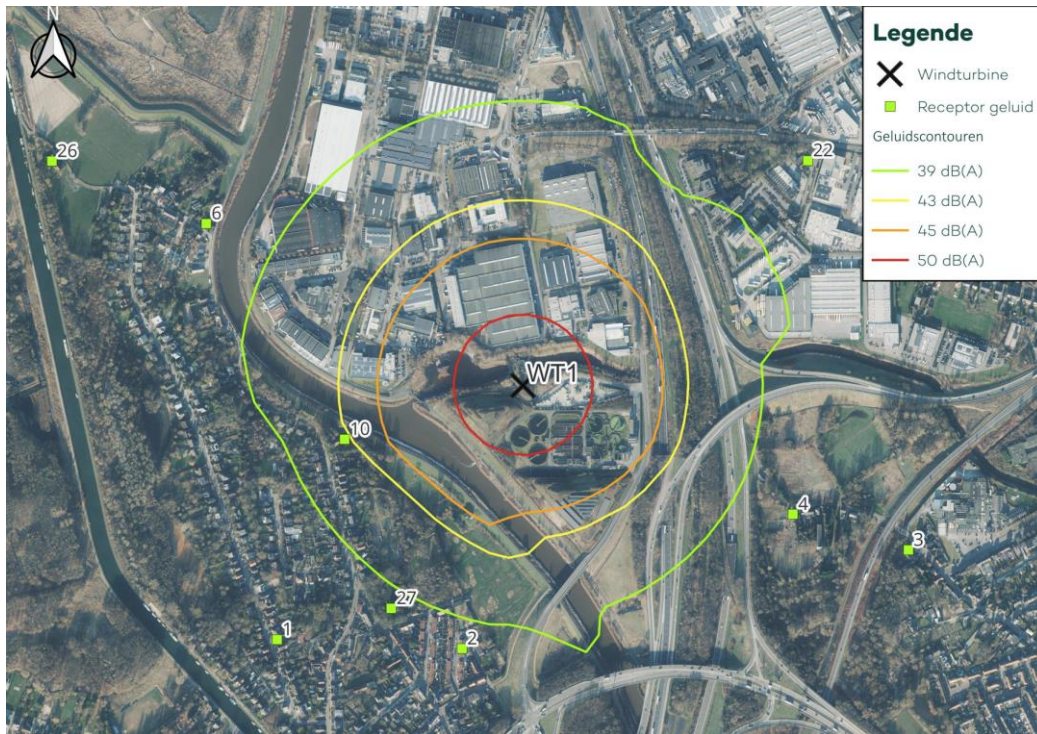
Figuur 8: Voorbeeld geluidsimpact nachtperiode in 'gereduceerde modus' (geluidscontouren avond- en nachtperiode in dB(A)) van een realistisch turbinetype dat in aanmerking komt bij vergunning van het dossier (Enercon E138 op 130m ashoogte)
