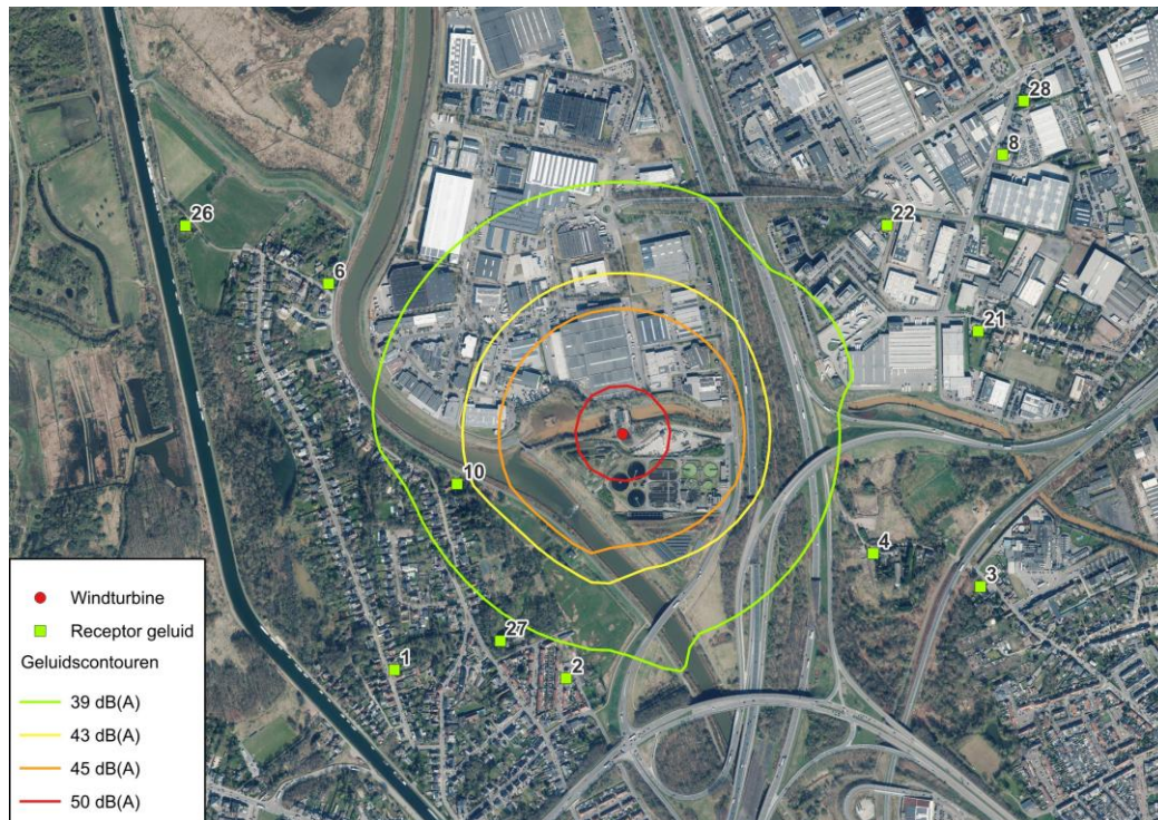
Figuur 8: Voorbeeld geluidsimpact nachtperiode in 'gereduceerde modus' (geluidscontouren avond- en nachtperiode in dB(A)) van een realistisch turbinetype dat in aanmerking komt bij vergunning van het dossier (Vestas V136 op 149m ashoogte)
