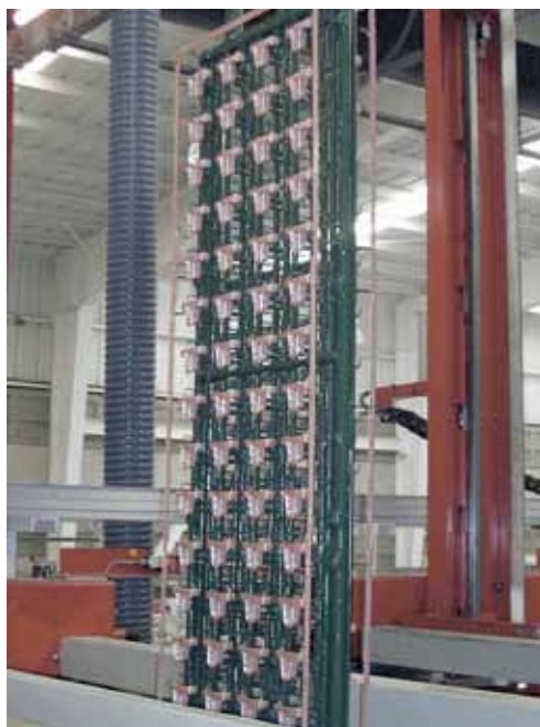
Abb. 9: Erster Durchlauf des Versuchsgestells in der Galvano-Anlage
