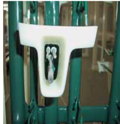
Abb. 8: Aufgesteckte Lenkradblende auf Versuchsgestell mit platinieren Innenanoden Figure 8: Steering wheel bezel mounted on the test rack with platinised auxiliary anodes
