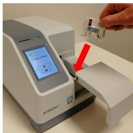
Plaats de cartridge in de analysator met de streepjescode naar links.
