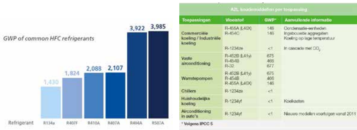
Figuur 129: GWP van veel gebruikte koelmiddelen (opm: de 'komma' in de getallen duidt het duizendtal aan, en is dus geen decimaal scheidingsteken). [The Greens / European Free Alliance – Shecco; Climalife]
