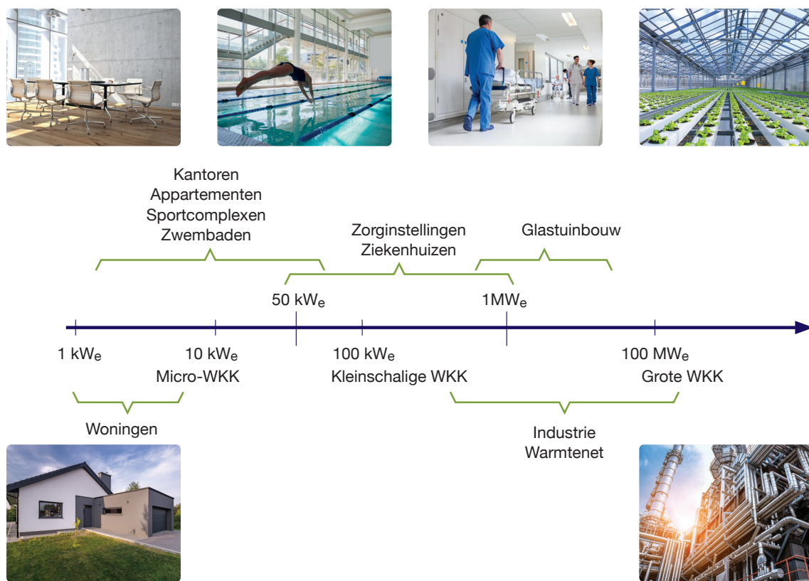
Figuur 14: Verschillende toepassingen van WKK met verschillende vermogens.
