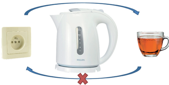
Figuur 4: Elektriciteit kan eenvoudig omgezet worden in warmte maar omgekeerd.
